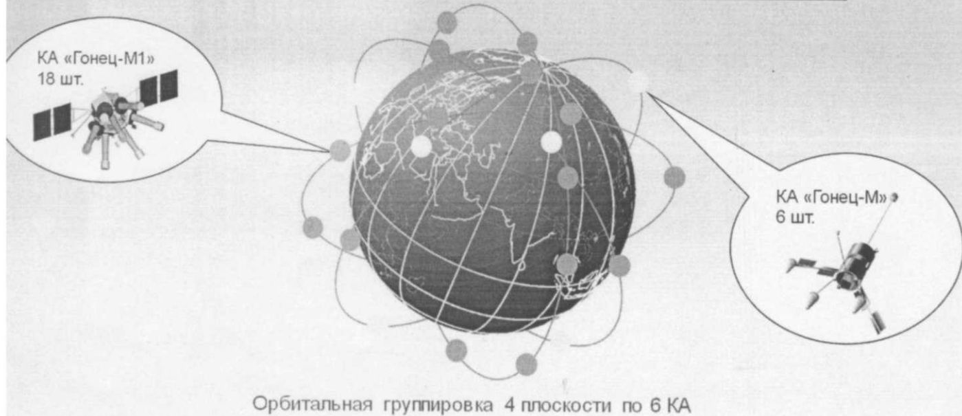
Рис. 5. Орбитальная группировка МСПСС «Гонец-Д1М»
