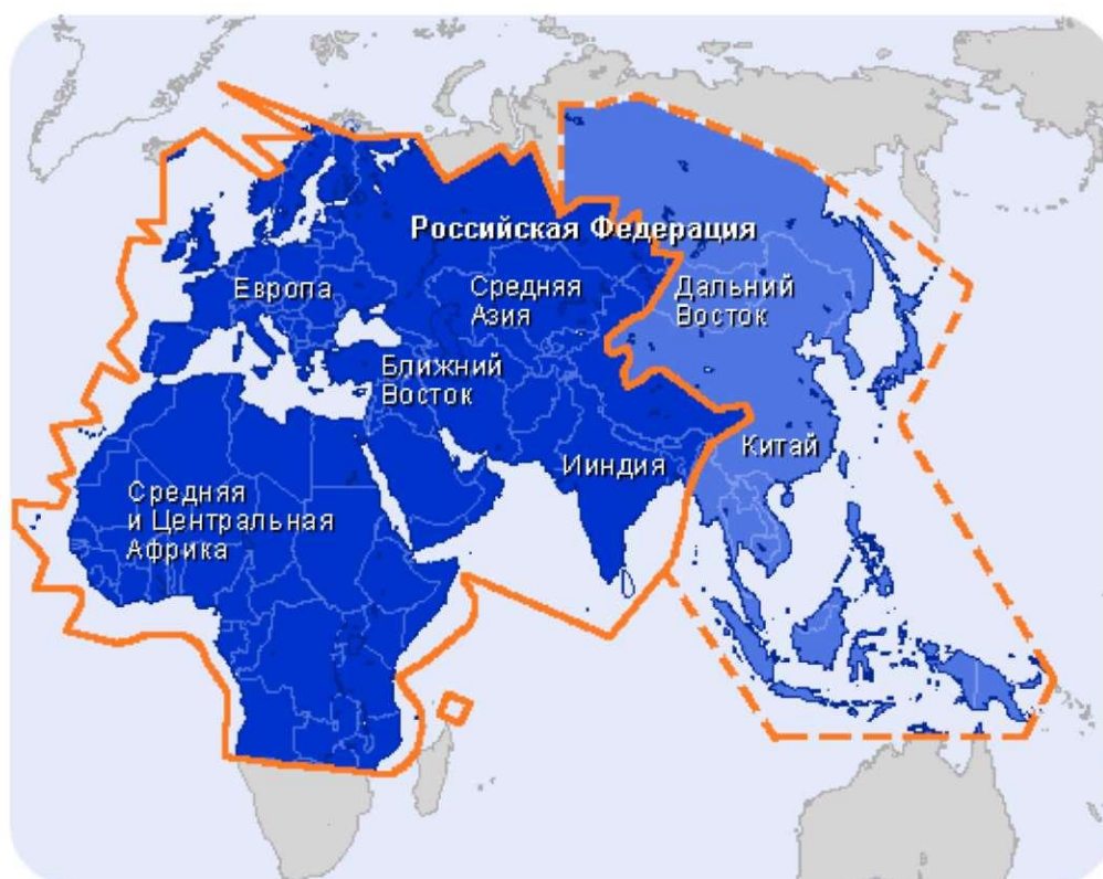
Рисунок 5.1. Карта покрытия системы Thuraya после ввода в эксплуатацию КА Thuraya-2 .
